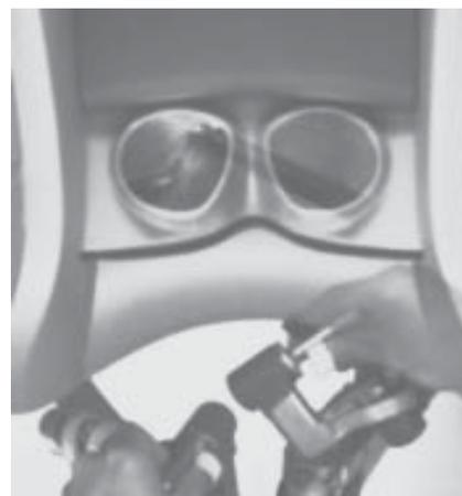
Рис. 3. Положение руки хирурга на джойстике во время выполнения операции (слева) и внешний вид панели консоли хирурга с видео 3D-изображением (справа)
