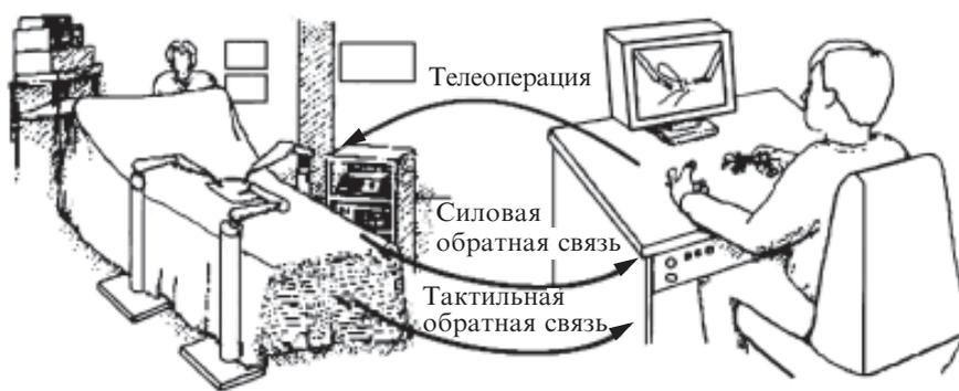
Рис. 1. Принципиальная схема организации работы телехирурга
