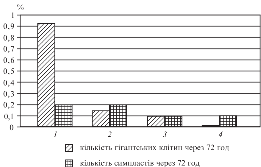
Рис. 4. Вплив алмазовмісного покриття медичних імплантатів на кількість гігантських клітин і симпластів, що утворилися в процесі розвитку культури RD: 1 — контроль; 2 — лавсан «чистий»; 3 — лавсан з тонким АП; 4 — лавсан з товстим АП
