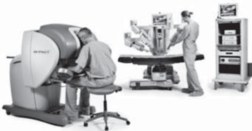
Рис. 2. Внешний вид хирургической консоли — «master» (передний план) и операционный стол с манипуляторами — «slave» (задний план) системы «Da Vinci»
