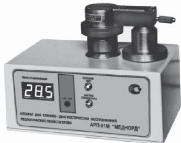
Рис. 1. Внешний вид аппарата для клинко-диагностических исследований реологических свойств крови АРП-01М «Меднорд»
